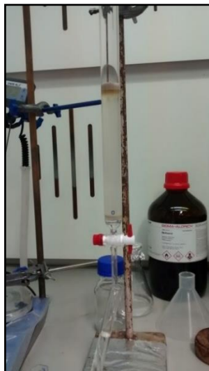
Figura 2 - Coluna cromatográfica preenchida com sílica gel 60 Å para purificação do biossurfactante.
