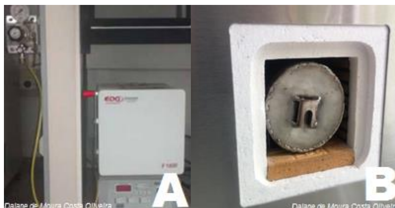
Figura 9 – (A) Forno tipo mufla fechado; (B) Forno tipo mufla aberto.
