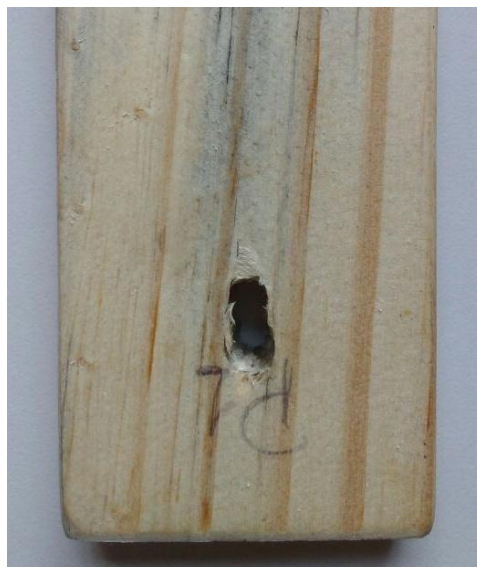
Figura 4.7: Deformações observadas no corpo de prova de pinus ensaiado para o modelo da norma brasileiro na direção paralela às fibras.
