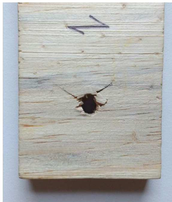
Figura 4.9: Cisalhamento observado em corpo de prova de pinus ensaiado para o modelo da norma brasileira na direção normal às fibras.
