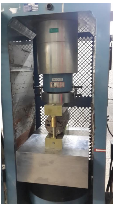
Figura 3: Ensaio de Compressão Diametral com corpo de prova entre as chapas resistentes.
