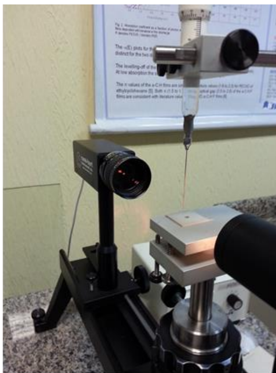
Figura 1: Ensaio de Goniômetro sendo realizado
