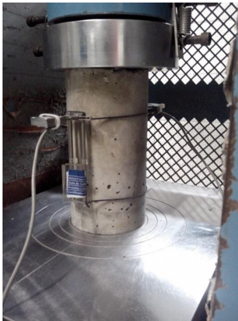
Figura 4: Ensaio de módulo de elasticidade com os medidores posicionados
