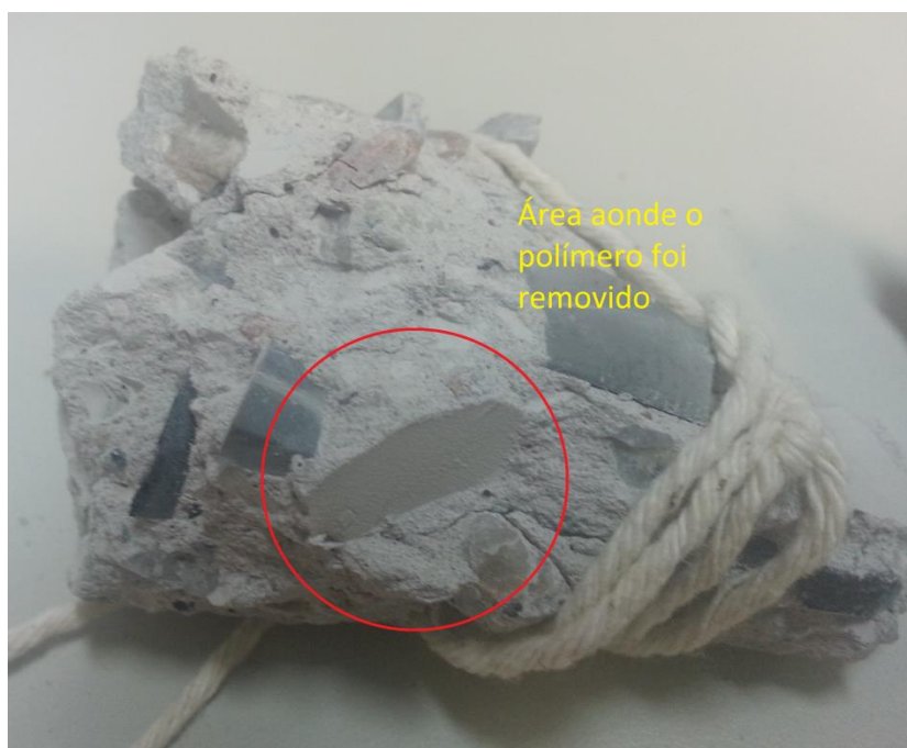
Figura 12: Amostra do concreto com incorporação com os locais onde o polímero se soltou.
