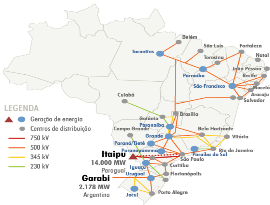
Figura 7: Sistema de Transmissão de Energia Elétrica no Brasil
