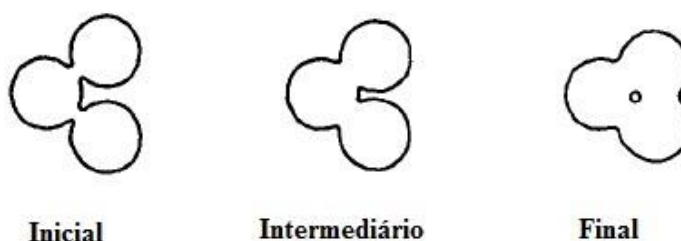
Figura 11: Estágios do processo de sinterização.
