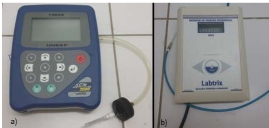
Figura 4.4: a) Equipamento leitor de gases; b) Medidor de pressão. Fonte: autora.
