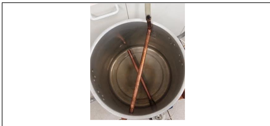
Figura 5 - Canos de cobre para circulação e refrigeração do mosto cervejeiro
