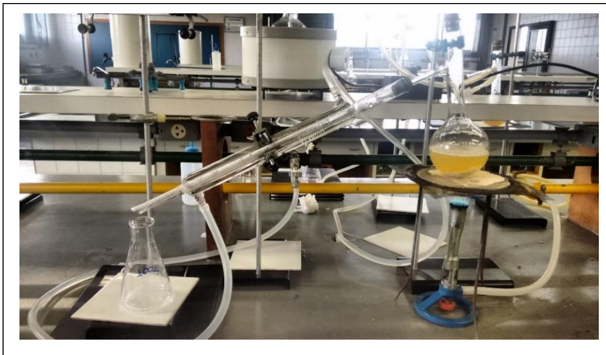
Figura 11 – Conjunto de destilação para descarbonatação da cerveja
