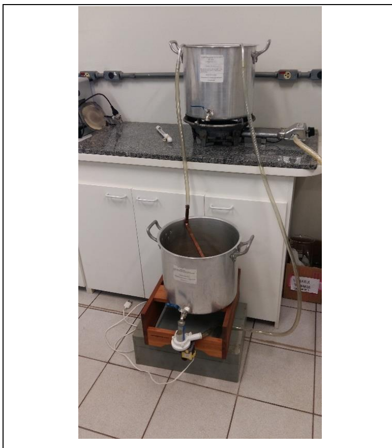
Figura 2 - Conjunto de panelas para brasagem, sendo que a superior faz o trabalho de troca de calor e a inferior, faz a mosturação.
