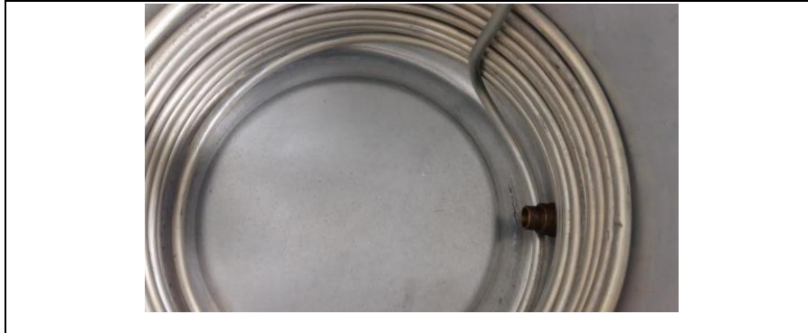
Figura 3 - Serpentina para recirculação do mosto cervejeiro
