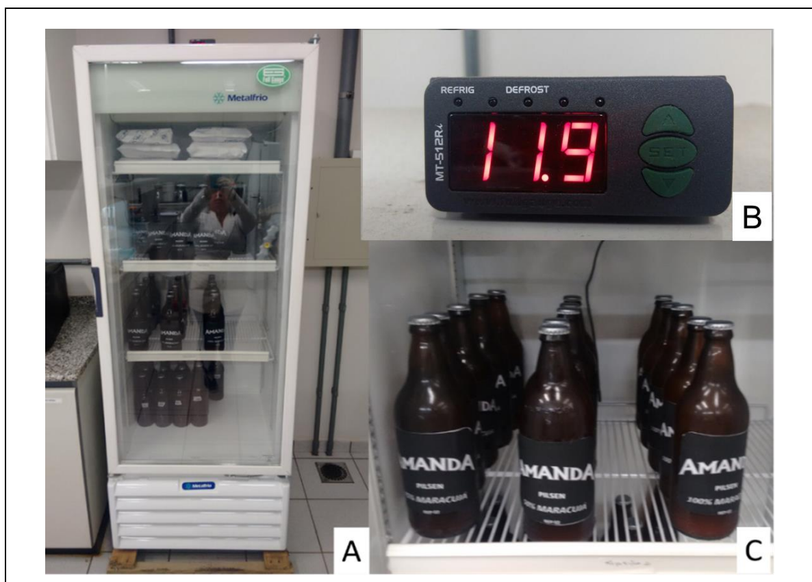
Figura 9 - Condicionamento da cerveja em geladeira adaptada com termostato para processo de maturação.
