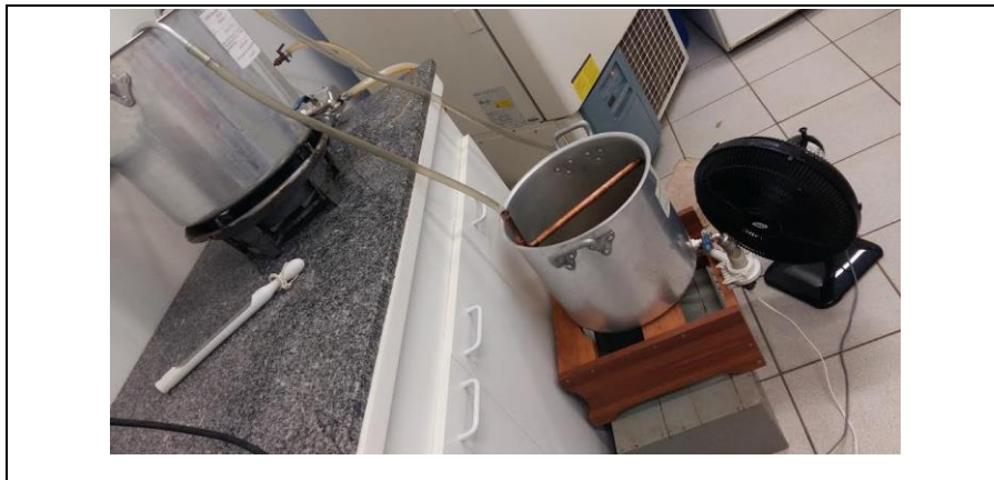
Figura 5 - Canos de cobre para circulação e refrigeração do mosto cervejeiro
