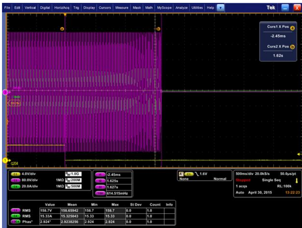
Figura 78 - Teste de detecção de ilhamento com carga RLC balanceada e 100% de carga
