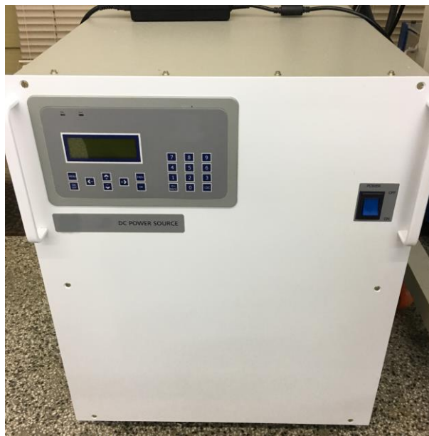
Figura 10 - Fonte CC programável utilizada na micro-rede.
