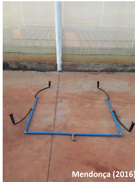
Figura 3 - Sistema de irrigação por aspersão montado para uma subparcela
