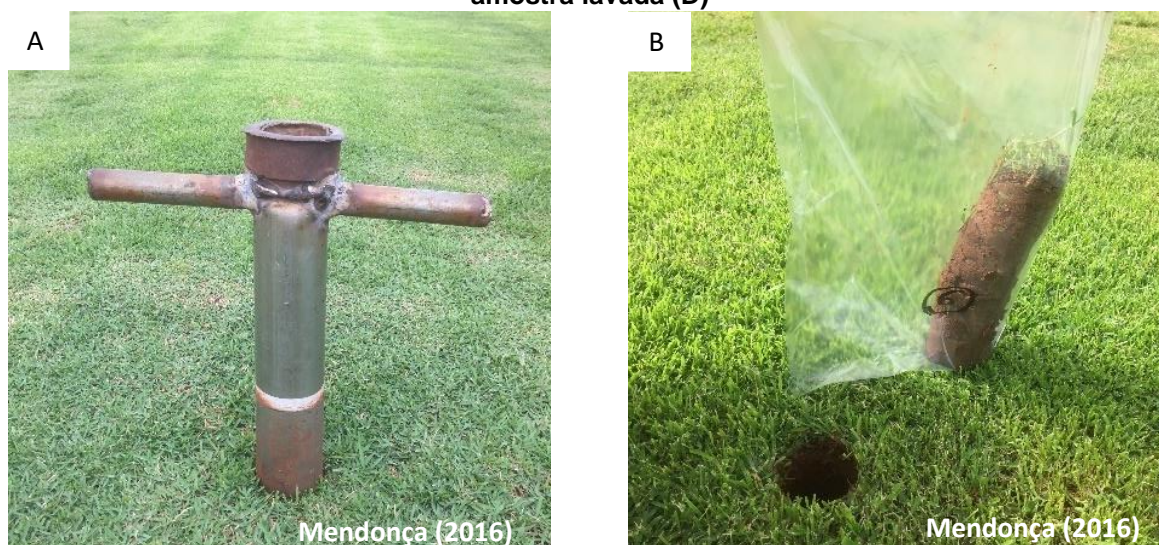
Figura 17 - Trado utilizado (A), amostra retirada (B), amostra sendo lavada na peneira (C) e amostra lavada (D)
