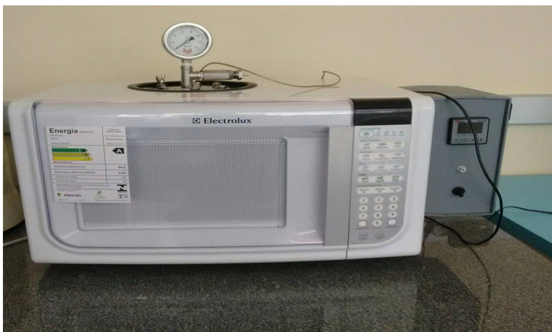
Figura. 5 - Microondas modificado utilizado no processo Solvotermal. Fonte: Fornecido pelo autor.
