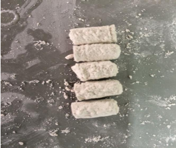
Figura 22: Corpos de prova para ensaio de compressão impressos com gesso puro antes do aquecimento (elaborada pelo próprio autor).
