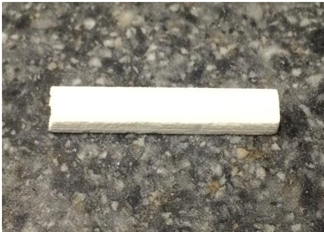
Figura 26: Corpo de prova manufaturado com pó alternativo + Pó importado e binder alternativo (elaborada pelo proprio autor).
