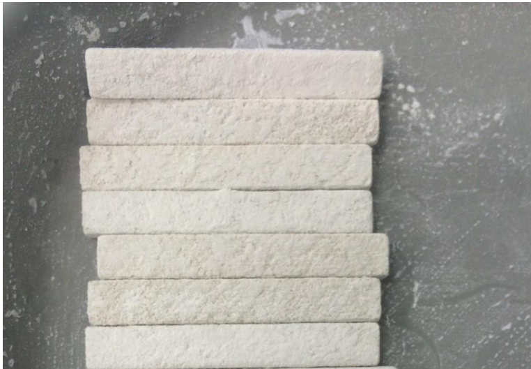
Figura 18: Corpo de prova manufaturado com binder importado (elaborada pelo próprio autor).
