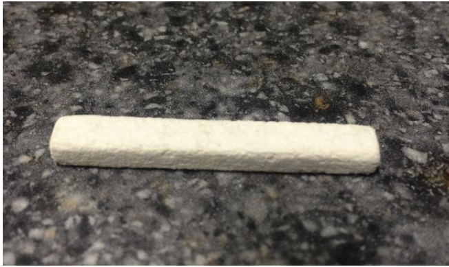
Figura 24: Corpo de prova manufaturado com binder e pó alternativos (elaborada pelo próprio autor).
