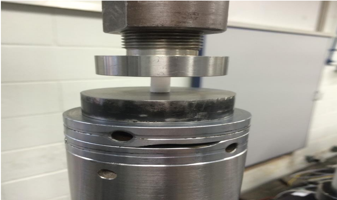
Figura 56: Corpo de prova sendo submetido a ensaio de compressão
