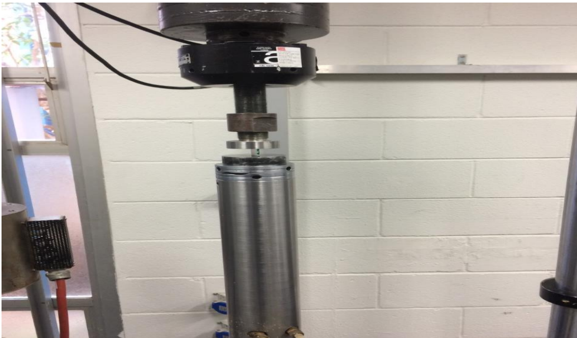
Figura 55: Corpo de prova sendo submetido a ensaio de compressão
