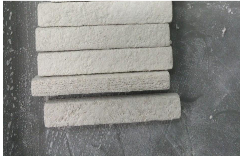
Figura 19: Corpos de prova manufaturados com binder nacional (elaborada pelo próprio autor).
