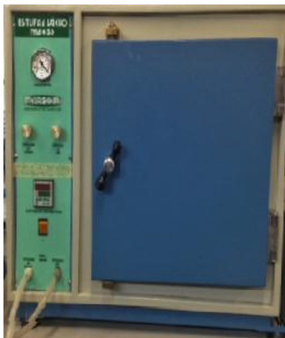
Figura 3. Estufa a vácuo utilizada na obtenção das microcápsulas.
