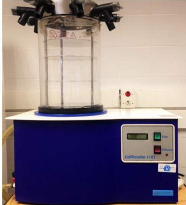
Figura 2. Liofilizador utilizado na obtenção das microcápsulas.
