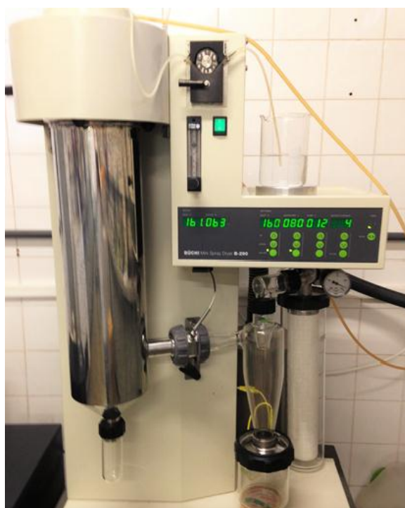
Figura 1. Spray dryer utilizado na obtenção das microcápsulas.
