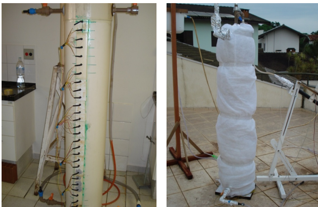
Figura 65: Sensores instalados no casco do reservatório térmico.
