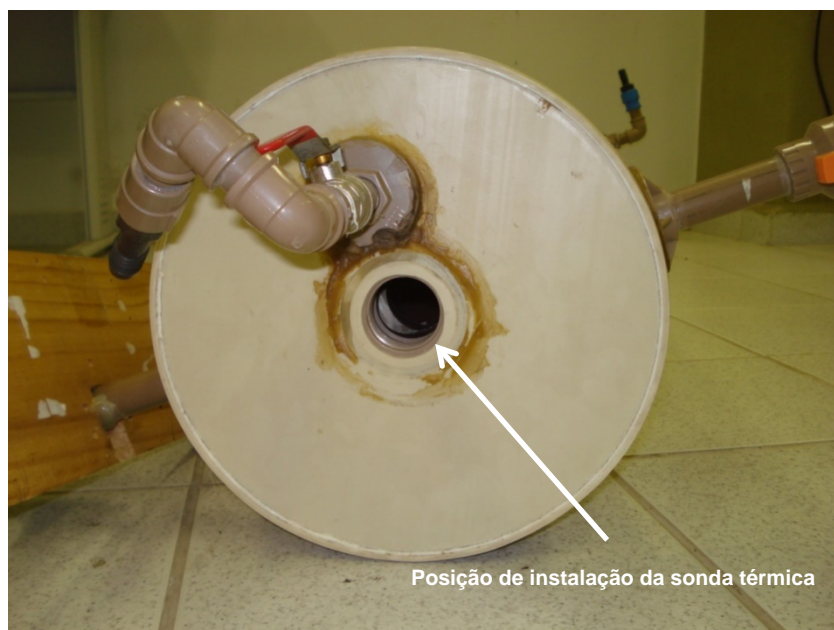
Figura 57: Local de instalação da sonda térmica.
