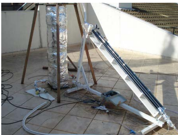
Figura 19: Concentrador parabólico composto (CPC) e coletor solar modificado.
