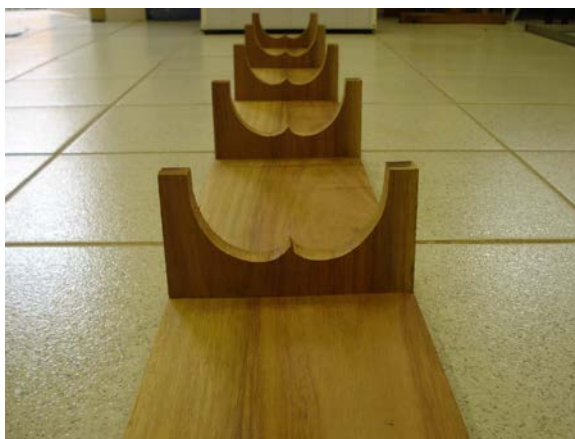
Figura 22: Apoio em madeira para o concentrador CPC.
