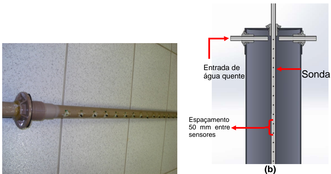
(a) Figura 56: a) Sonda térmica – v.1; b) Montagem da sonda térmica.
