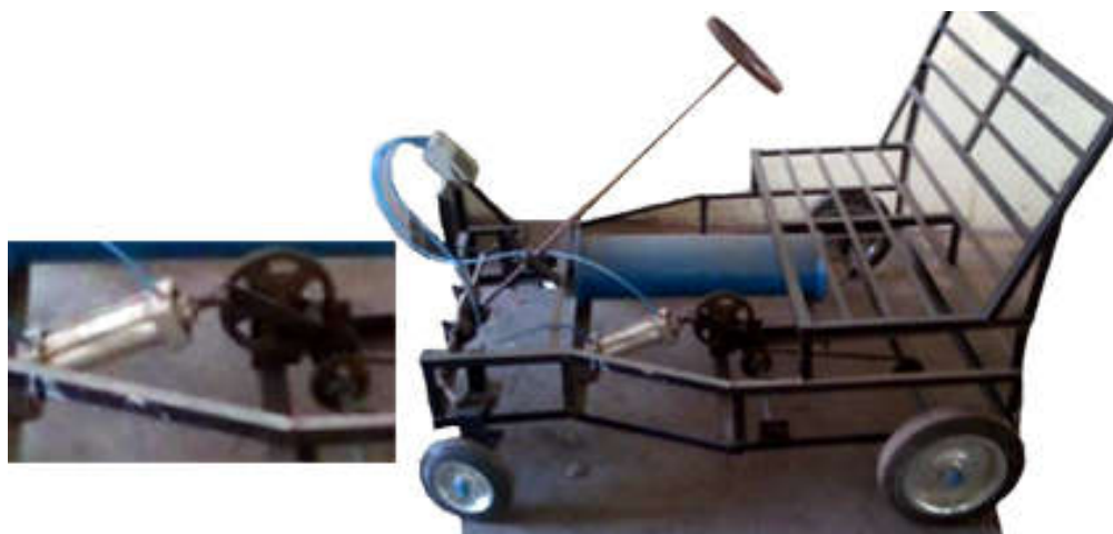
Figura 31 – Motor a ar comprimido com biela variável utilizando cilindro pneumático e manivela
