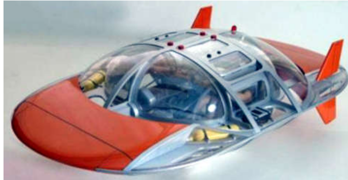
Figura 42 – Submarino com motor biomecânico a pedal de baixo peso e fácil manobrabilidade
