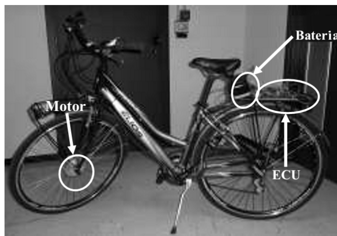
Figura 17– Protótipo de bicicleta híbrida com fontes híbridas biomecânica e elétrica
