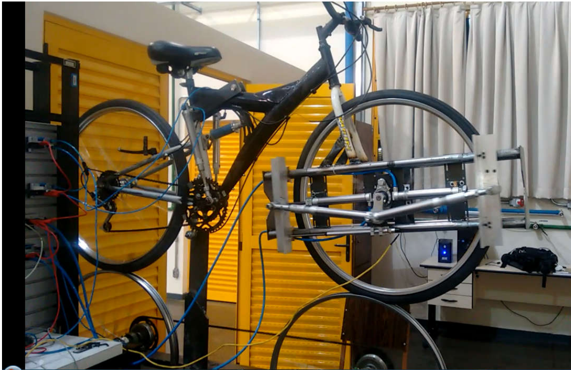
Figura 88 – Montagem do experimento exploratório passivo do sistema veicular bicicleta híbrida
