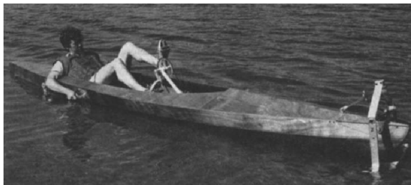
Figura 41 – Barco com motor biomecânico a pedal e suportes de baixo arrasto aerodinâmico
