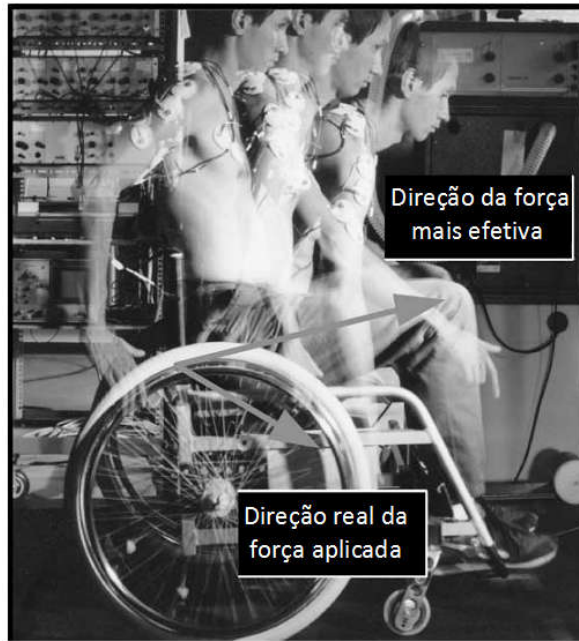
Figura 40 – Motor biomecânico manual aplicado ao veículo cadeira de rodas
