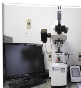
Microduromêtro Buehler Carga 5g; Tempo 10 segundos
