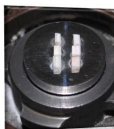
Embutimento dos blocos de esmalte com resina acrílica
