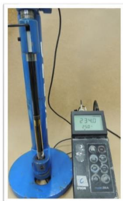
Fluoreto - Eletrodo específico (Orion 9409) - Eletrodo de referência (Orion 900200) - Analisador de íons (Orion 720A+).
