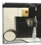
Micrômetro eletrônico digital com saída acoplado a uma base de microscópio e blocos fixados
