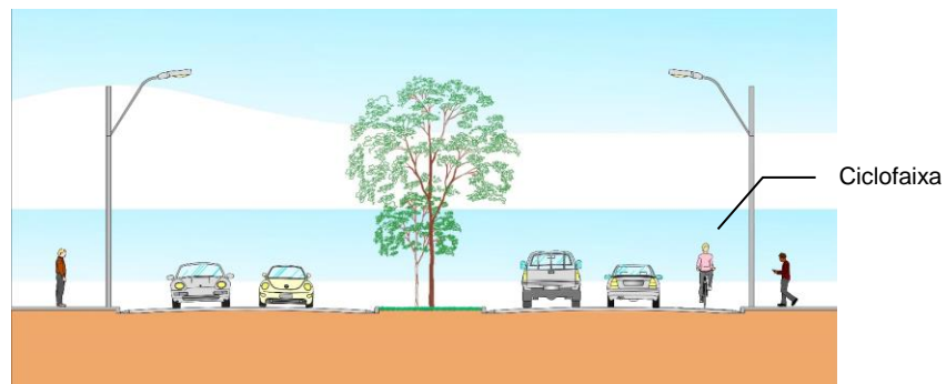
Figura 51 - Seção transversal do sistema viário – 6º segmento, sem escala
