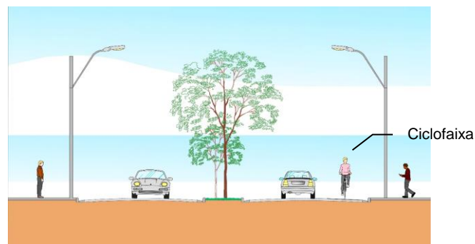
Figura 48 - Croqui do 5º segmento da ciclofaixa, sem escala
