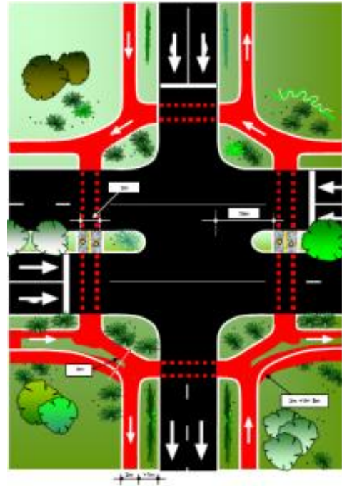
Figura 4 - Cruzamento entre duas vias margeadas por ciclovia
