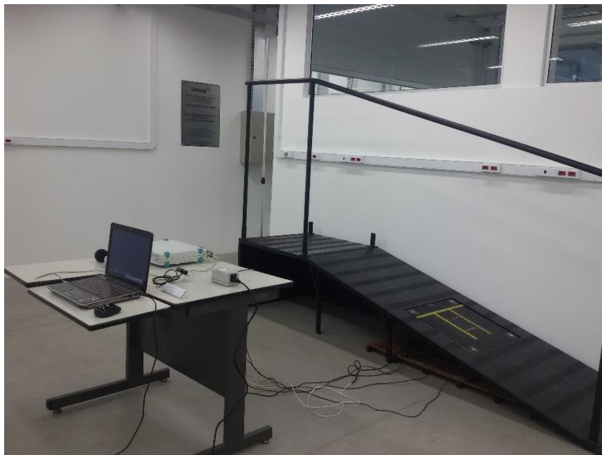
Figura 9 – Estrutura da rampa com a plataforma de força acoplada, pronto para análise.
