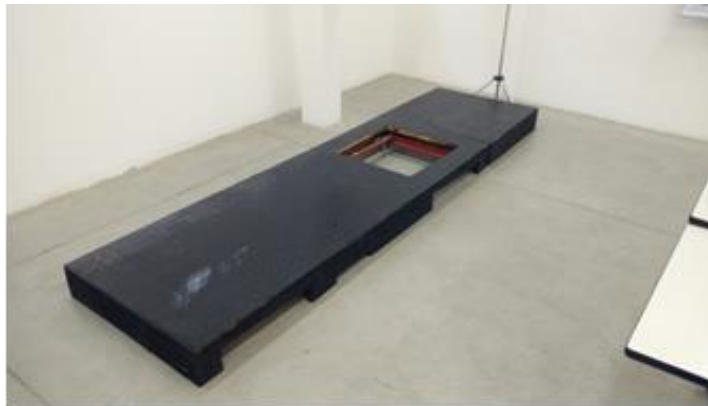
Figura 2 – Platô horizontal, com abertura para encaixe da plataforma de força.
