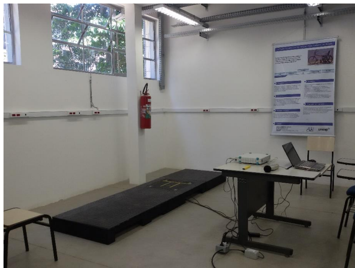
Figura 3 – Platô horizontal, com a plataforma de força acoplada, pronto para análise.
