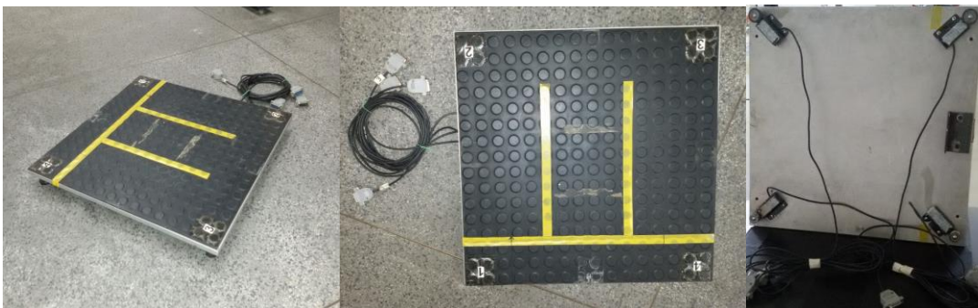
Figura 1 – Plataforma de força construída no Laboratório de Biomecânica do Departamento de Engenharia Mecânica da Faculdade de Engenharia de Guaratinguetá (FEG) / Universidade do Estadual Paulista (UNESP).
