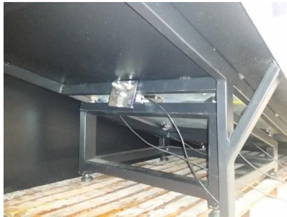
Figura 8 – Base de suporte com fixação da célula de carga R5 à rampa.
