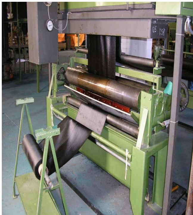
Figura 13 – Processo de pré-impregnação na Plastflow.
