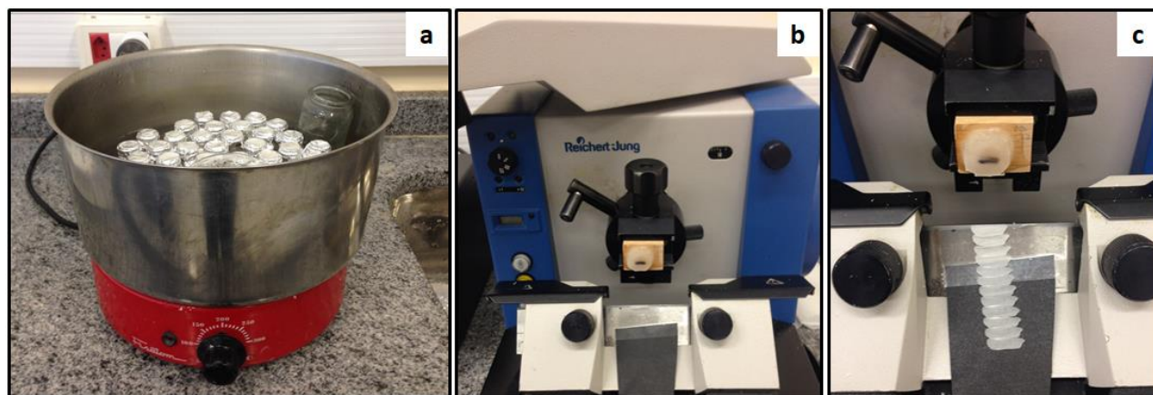
Figura 2. (a) Microamostras em solução de glicerina e água destilada (1:10), submetidas a banho-maria a 90°C. (b, c) Microamostras emblocadas em Polietilenoglicol 1500 (PEG 1500).
