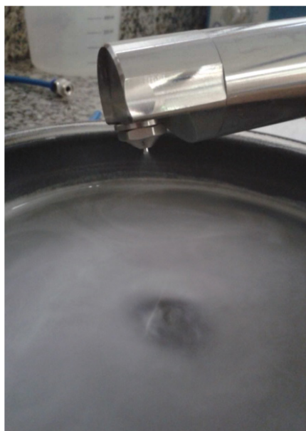
Figura 9: Bico nebulizador utilizado na obtenção das NPP pelo método de nebulização – geleificação ionotrópica.
