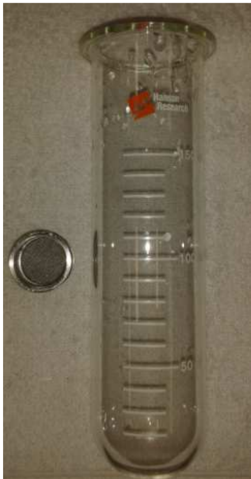
Figura 5: Conjunto de cesto e cuba de volume reduzido (150 mL) utilizados nos ensaios de liberação in vitro do fármaco.
