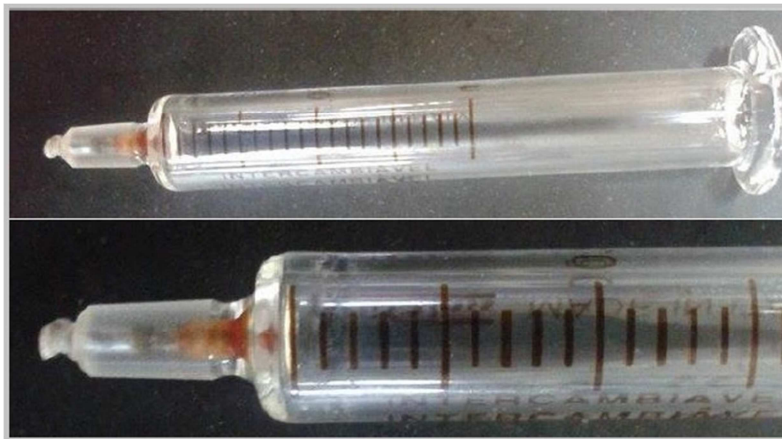
Figura 3: Seringa de vidro graduada, com a extremidade inferior vedada, para avaliação do intumescimento das microesferas.
