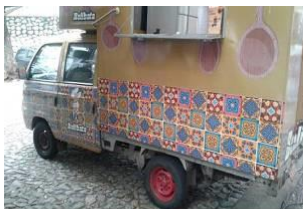
Figura 16 - Automóvel utilitário “ food truck ” com aplicação vinílica padrão azulejo
