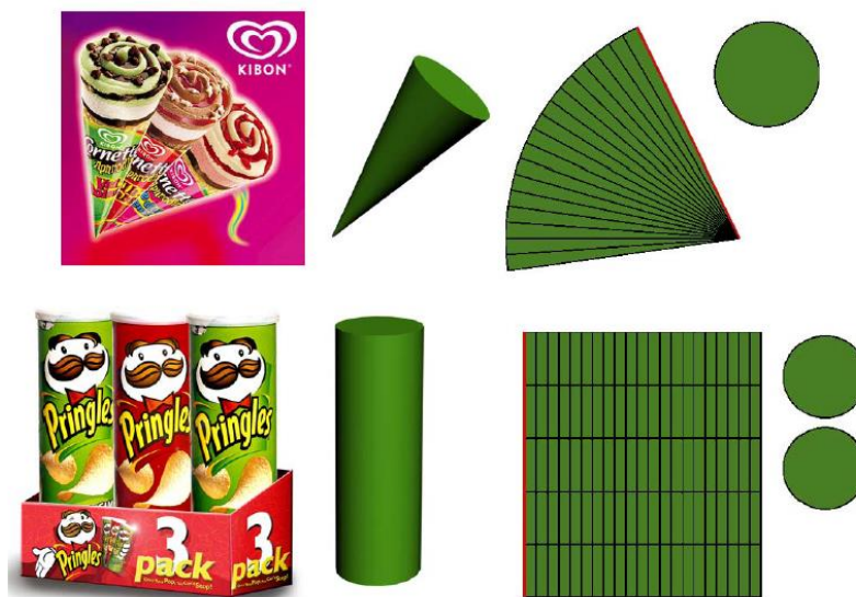
Figura 42 - Embalagens com superfícies cônicas e cilíndricas
