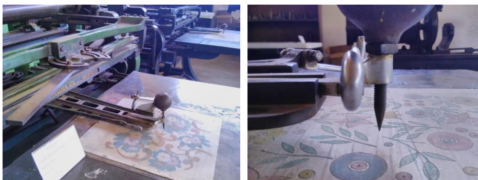
Figura 12 - Pantógrafo sobre placas metálicas para gravação de padrões para tecidos
