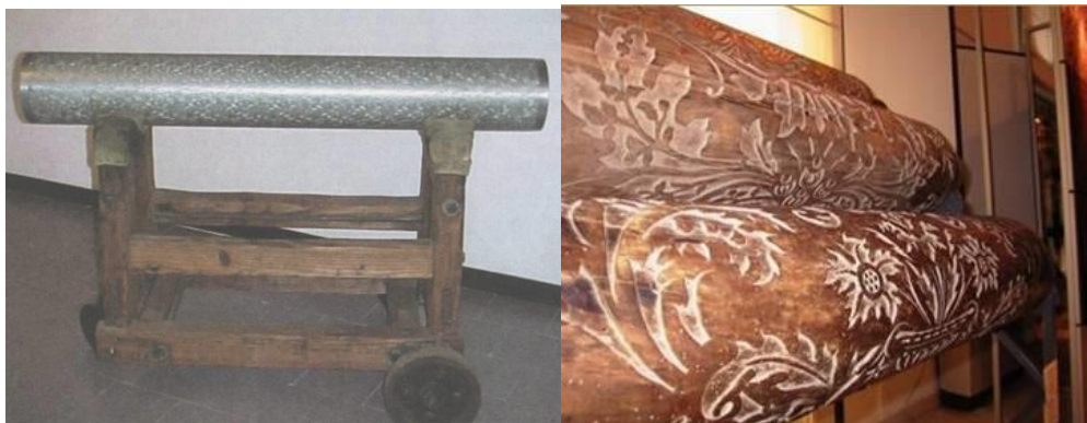
Figura 11 - Cilindro metálico e cilindro em madeira para estamparia de tecidos.
