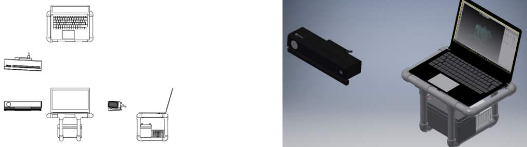
Figura 28. Sistema de medidas Artec Studio 11® + Sensor Kinect.
