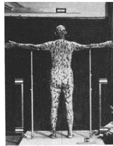
Figura 21. Sistema de medições por estéreo fotogrametria em humanos. Fonte: Hertzberg et al. (1956)
