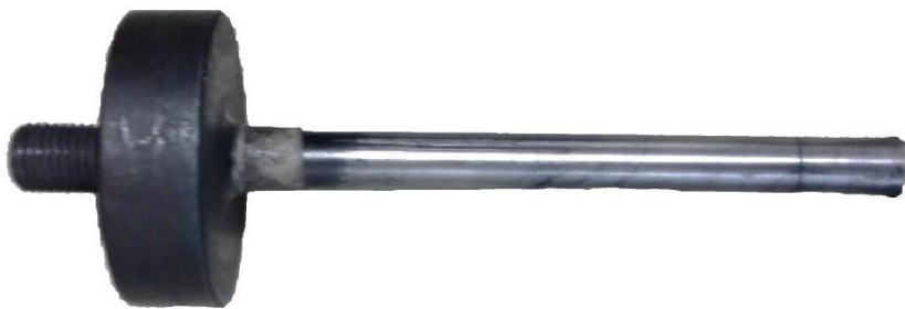
Figura 35 – Punção para ensaio ECAP
