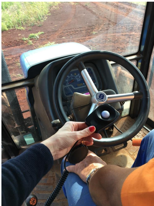
Figura 18 – Luxímetro posicionado no centro da cabine.
