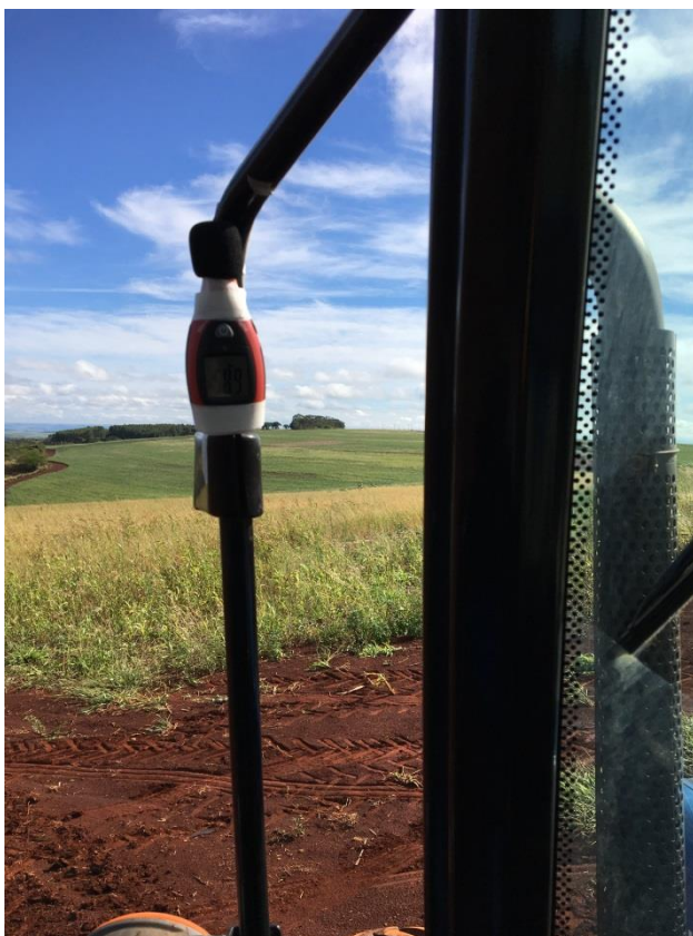
Figura 14 – Decibelímetro fixado na parte externa do trator para coleta de dados.
