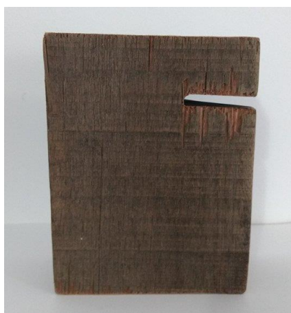
Figura 20 – Exemplo de toco de madeira com abertura específica para encaixe do gancho.
