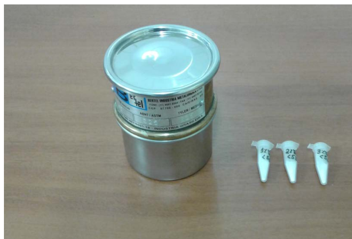
Figura 20: Fotografia da peneira e do material pulverizado com tamanhos de partículas < 45 \mu\text{m} .
