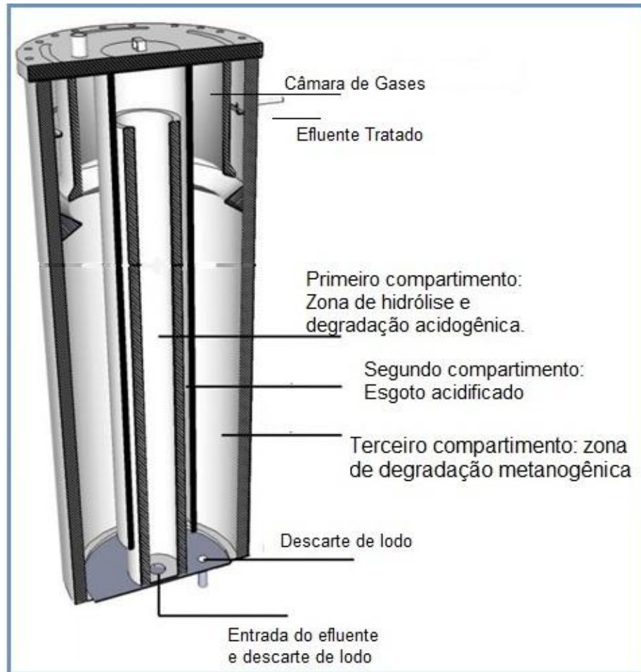
Figura 6 – Representação do corte longitudinal do RUC
