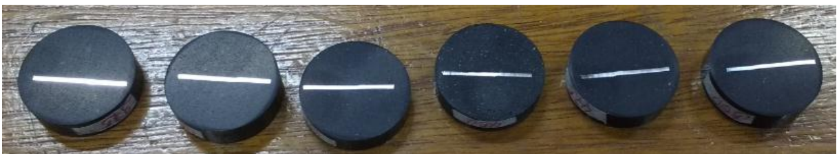
Figura 30 – Amostras embutidas para os ensaios de macro e microscopia
