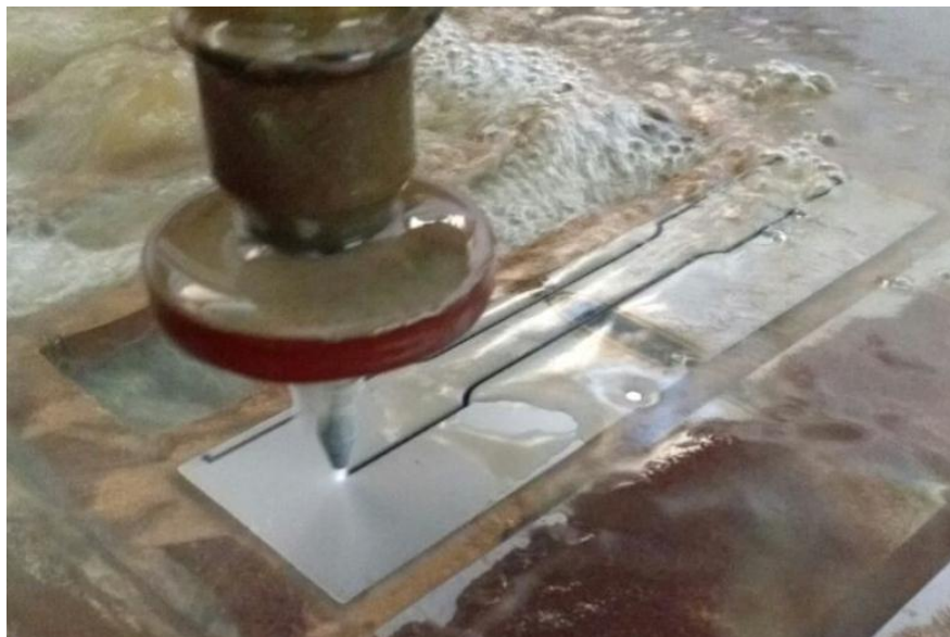
Figura 36 – Corpo de prova sendo confeccionado pelo processo de corte com jato de água
