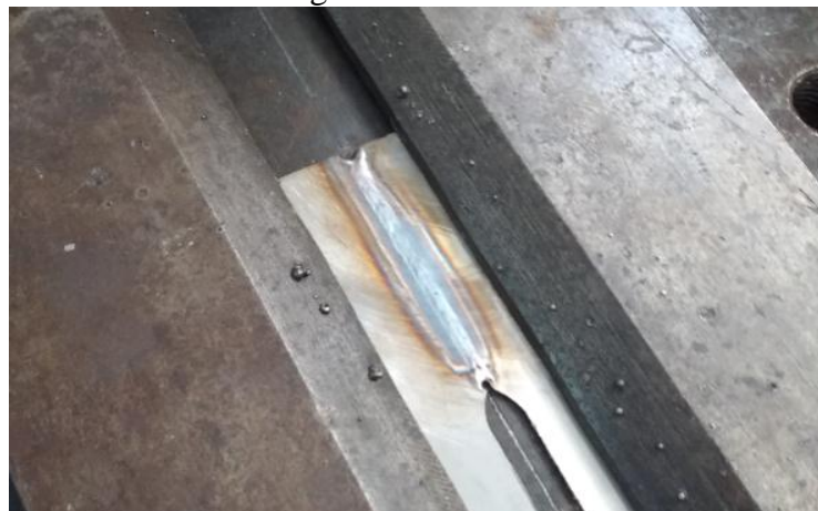
Figura 28 – Cordão de solda com parâmetros de soldagem da Tabela 9 e velocidade de soldagem de 375 mm/min
