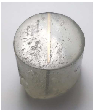
Figura 10 - Amostra embutida em resina para medida de espessura por MEV.
