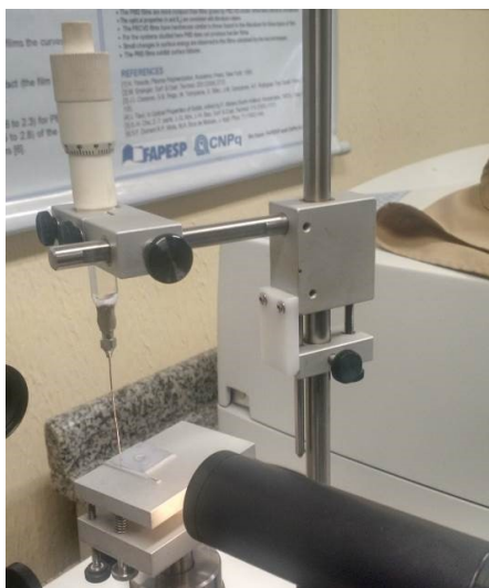
Figura 12 - Goniômetro durante o teste de molhabilidade.
