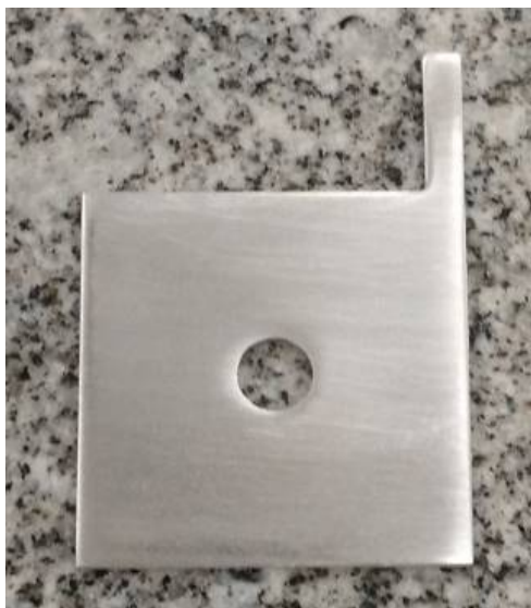
Figura 7 - Geometria do substrato de liga de alumínio 5052.
