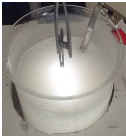
Figura 9 - No centro da cuba eletrolítica observa-se uma região luminosa, correspondente aos micro-arcos espalhados sobre o substrato de alumínio.
