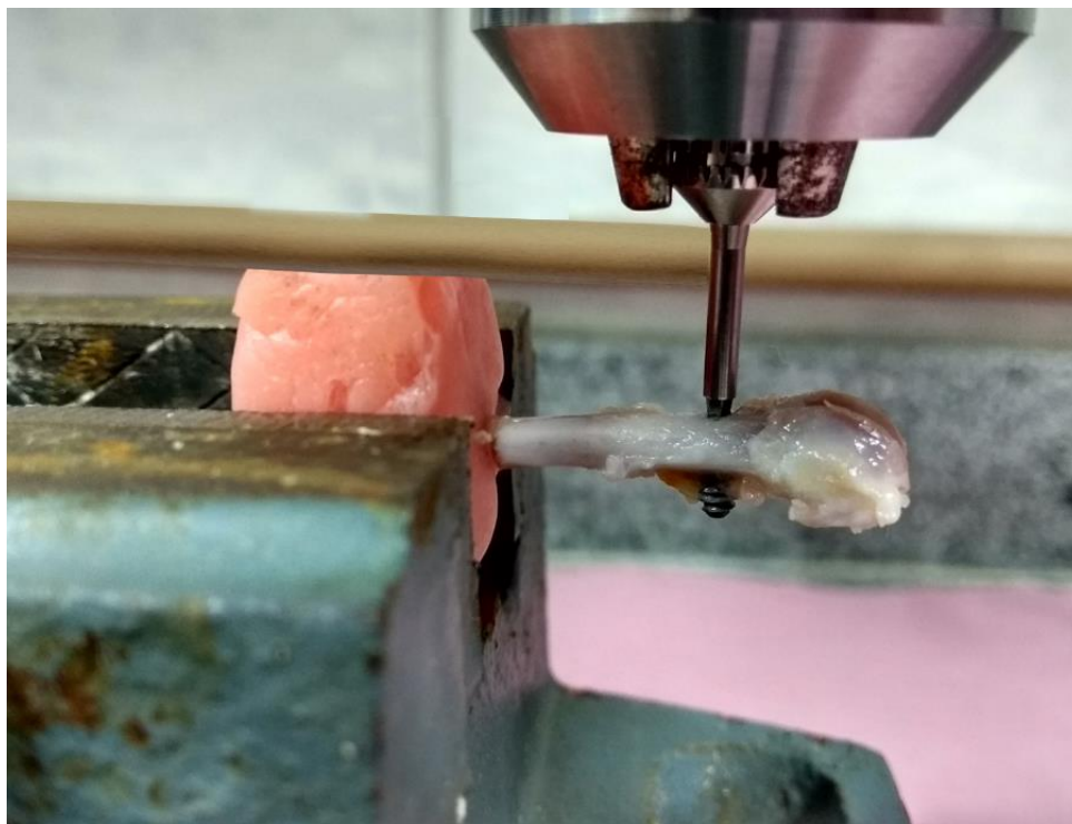
Figura 8 - Padronização do fêmur, incluído em RAAQ, para realização do teste mecânico de torque reverso
