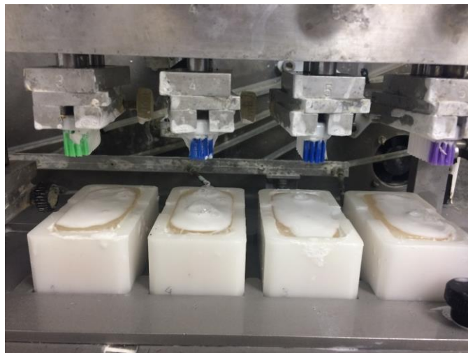
Figura 5- Suportes e escovas posicionados na máquina de escovação, com o “ Slurry ”, cobrindo totalmente as amostras
