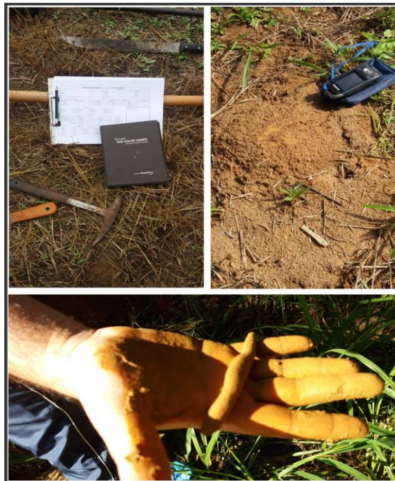
Figura 12 – Instrumentos para análises visuais e de textura dos solos em campo
