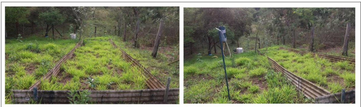
Figura 29 – Parcela experimental da calha coletora de Gerlach no setor sudeste do sítio Lagoa Grande em área de pasto sujo.
