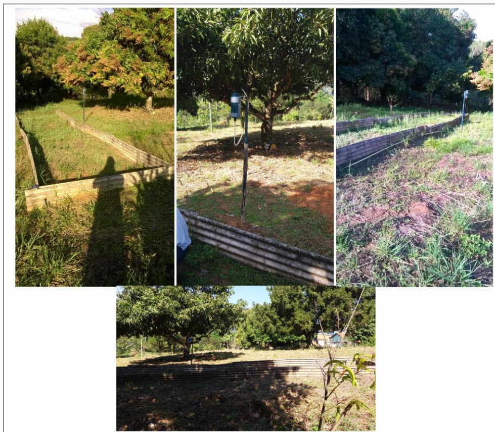
Figura 32 - Parcela experimental da calha coletora de Gerlach no setor sudeste do sítio Lagoa Grande em área de cultivo perene.
