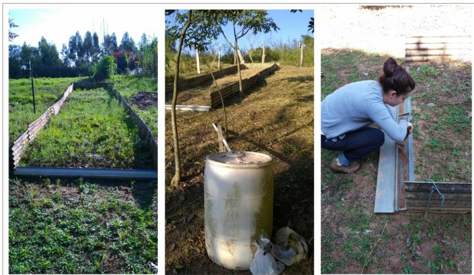
Figura 15 – Parcelas Experimentais de Calhas de Gerlach instaladas no sítio Lagoa Grande.
