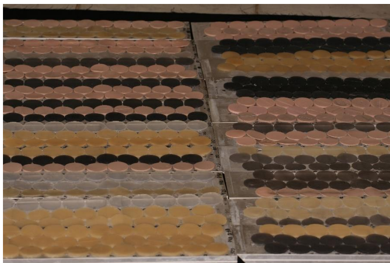
Figura 12. Exemplo de amostras fixadas nas placas para realização do Ensaio de Envelhecimento Acelerado.
