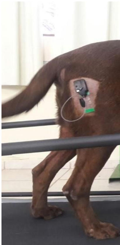
Figura 2 – Detalhe aproximado do posicionamento da mini-cabeça do sensor sobre a musculatura do bíceps femoral direito.
