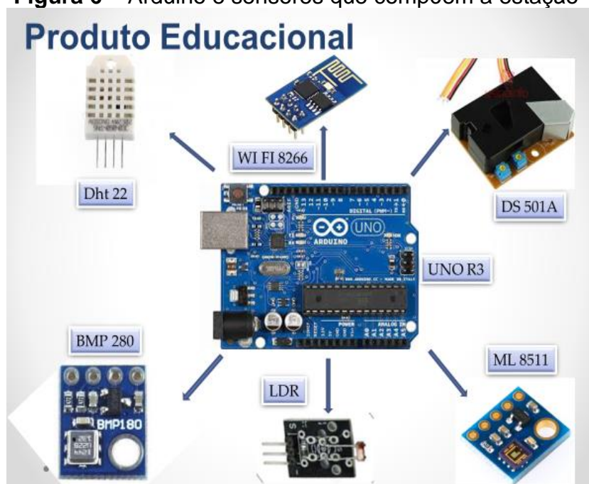
Figura 6 – Arduino e sensores que compõem a estação
