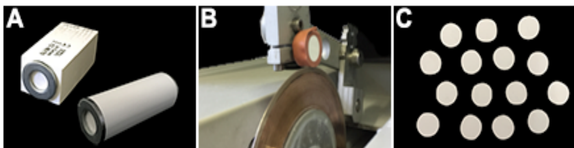
Figura 8 – Esquema de confecção dos discos de zircônia
