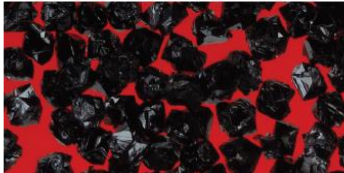
Figura 10: Grãos abrasivos de um rebolo CBN HF.
