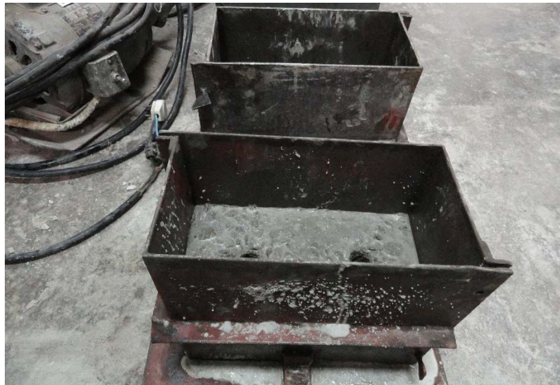
Figura 54- Corpo de prova moldado com orifícios.
