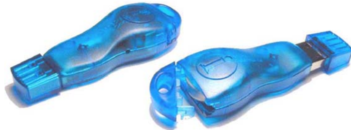
Figura 49 - Leitor de iButton DS9490B com interface USB.
