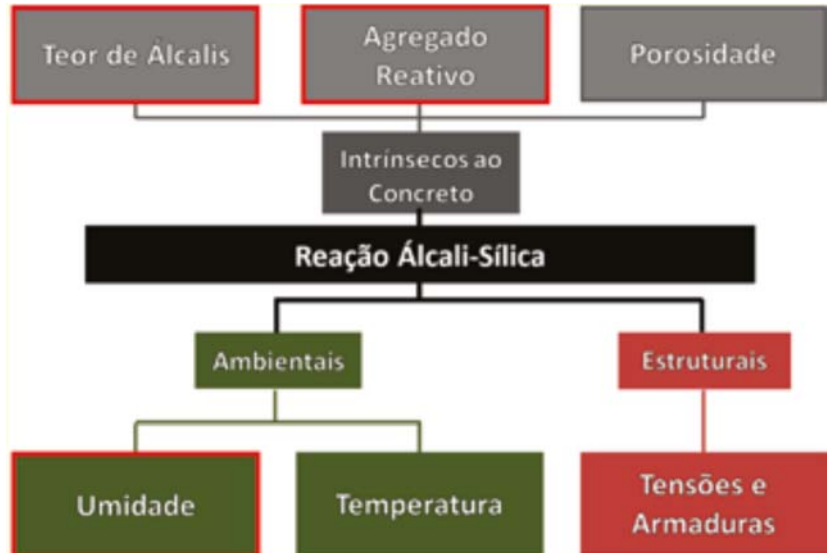
Figura 4 - Principais fatores que influenciam a reação álcali-silica.
