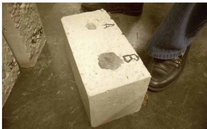
Figura 57 - Vedação dos orifícios.
