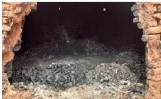
Figura 4. Ilustração de um mesmo forno rabo quente, do qual foi removido o carvão vegetal comercial e restou a moinha: A) exterior do forno; B) interior do forno.
