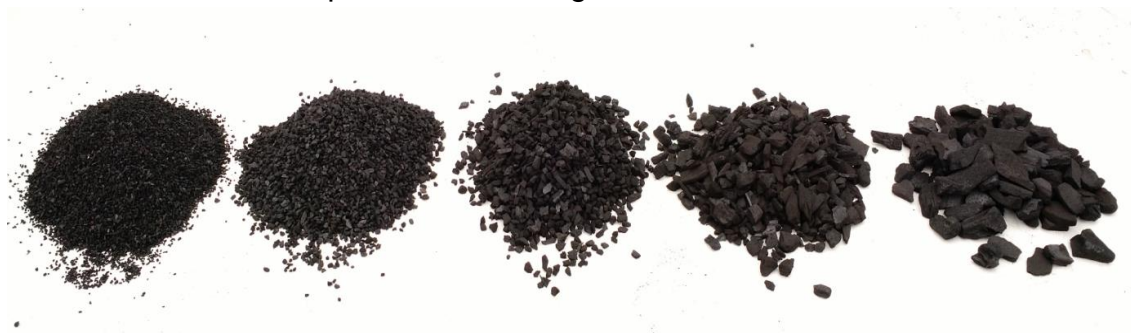
Figura 7. Granulometrias de carvão, de 1 a 2 mm, 2 a 4 mm, 4 a 8 mm, 8 a 16 mm e 16 a 32 mm, respectivamente a figura.
