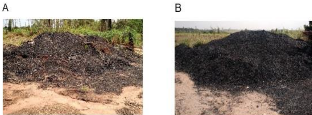
Figura 2. Resíduos sólidos de carvão vegetal: A) moinha de carvão vegetal descartada no meio ambiente; B) fino de carvão vegetal após o processo de separação por peneiramento mecânico.
