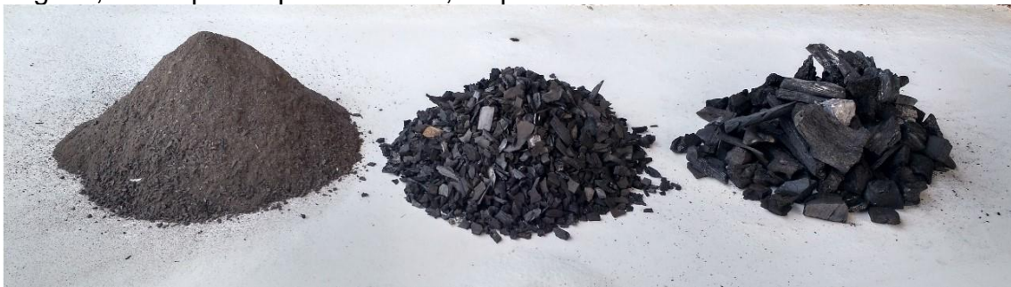
Figura 3. A moinha separada em três frações, pó, fino e granulado de carvão vegetal, da esquerda para a direita, respectivamente.
