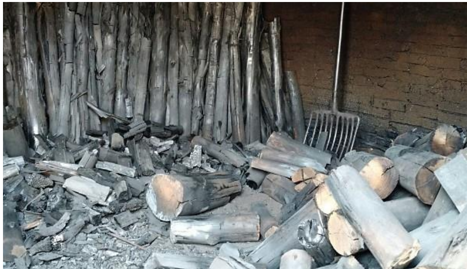
Figura 5. Interior de um forno de alvenaria, com presença de madeira que não foi totalmente carbonizada.
