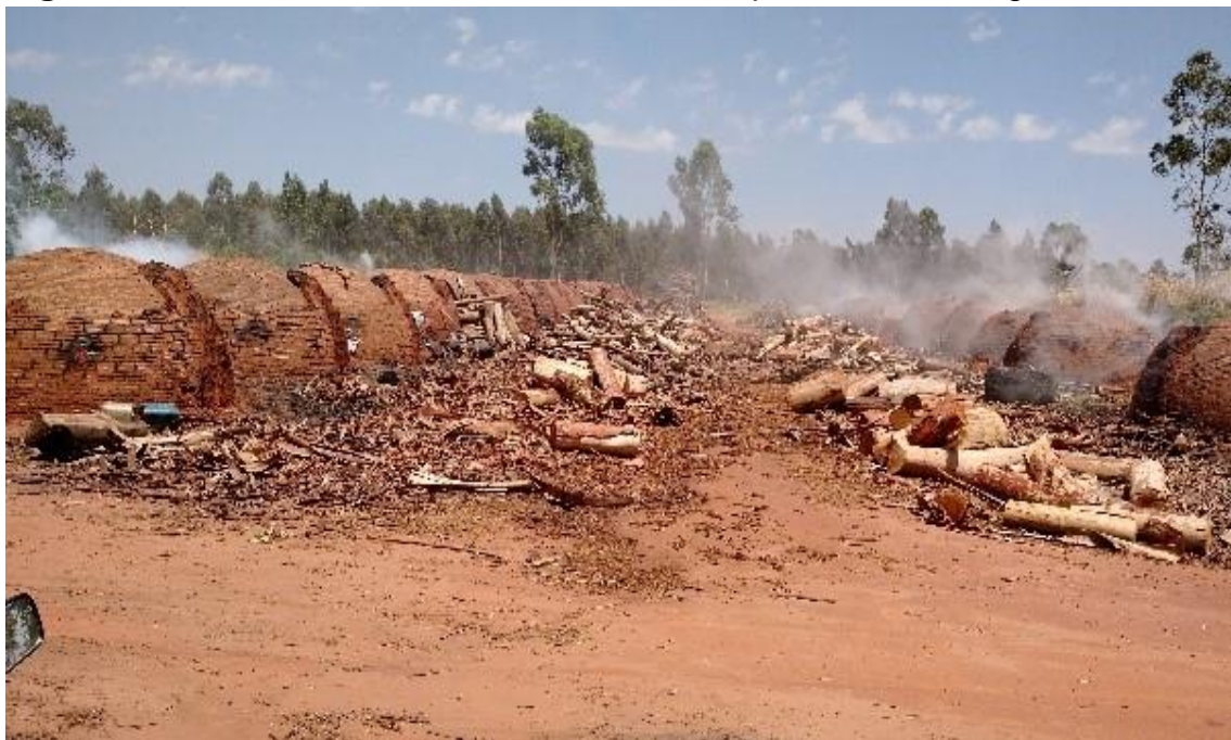
Figura 6. Exterior de fornos de alvenarias rabo quente, emitindo gases tóxicos.
