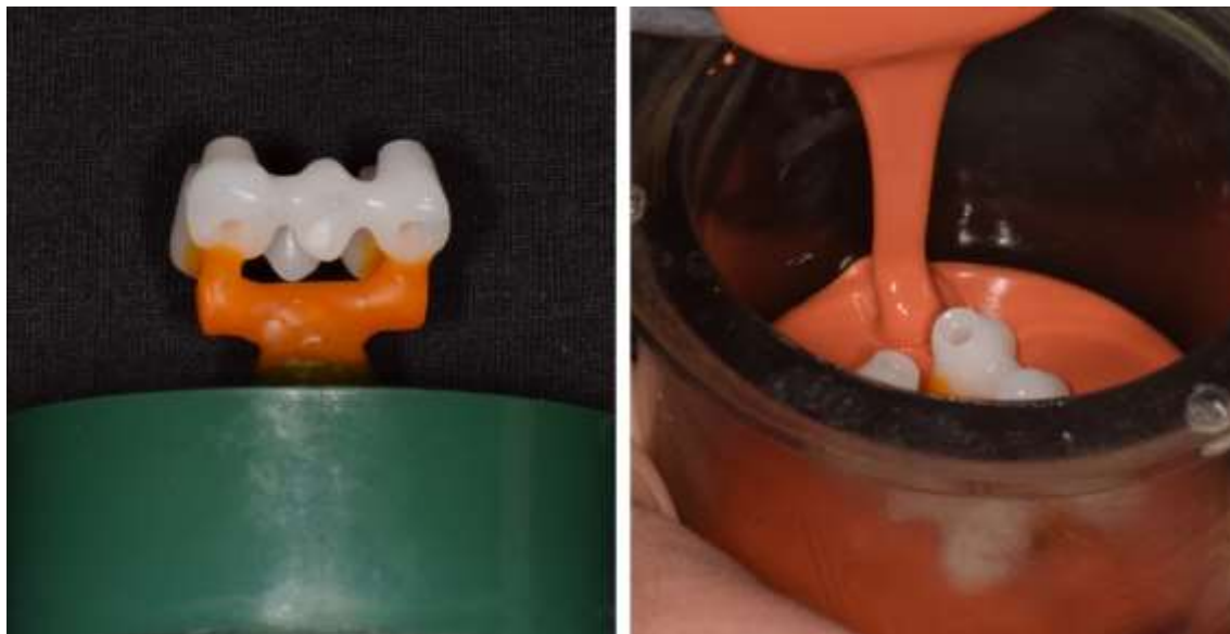
Figura 10. Inclusão das infraestruturas em material de revestimento
