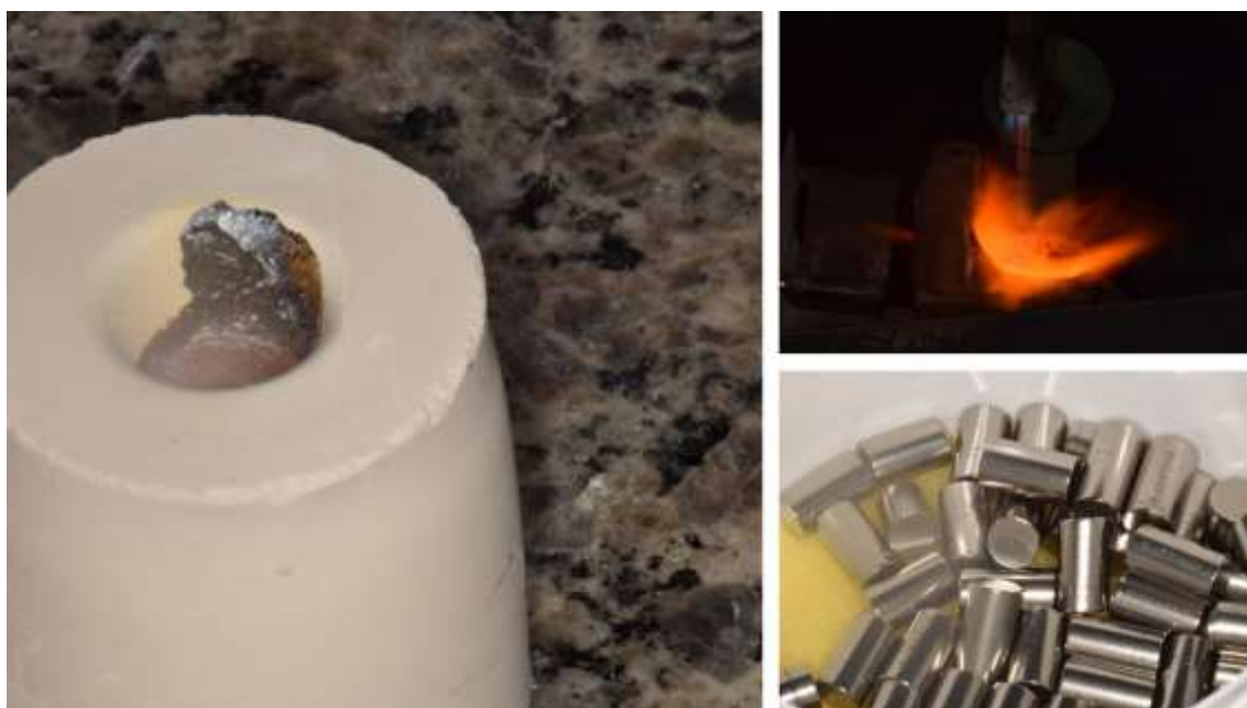
Figura 11. Fundição com a liga de Ni-Cr
