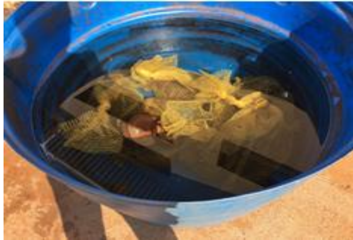
Figura 5. Tanque de PVC preenchido com água para a saturação dos discos. Ilha Solteira/SP, 2017.
