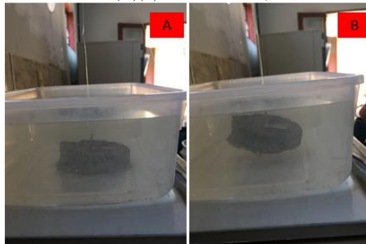
Figura 6. Balança hidrostática utilizada para quantificar a massa úmida ( P_u ) (A) e massa imersa ( P_i )(B). Ilha Solteira/SP, 2017.
