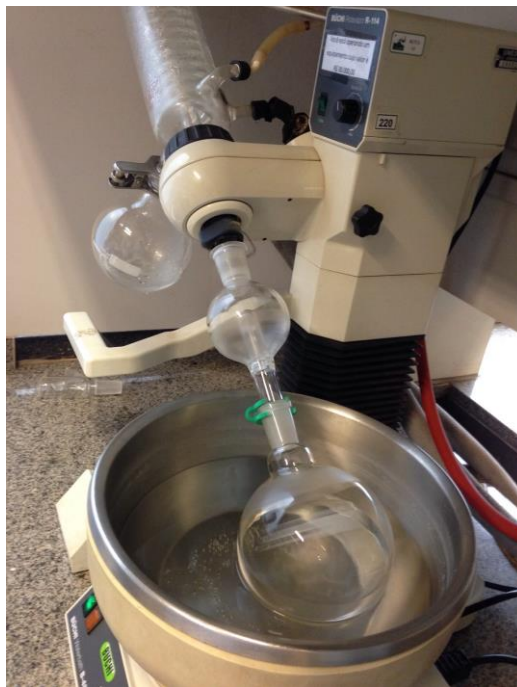
Figura 2 - Remoção do solvente orgânico sob vácuo em evaporador rotatório da Buchi R-114
