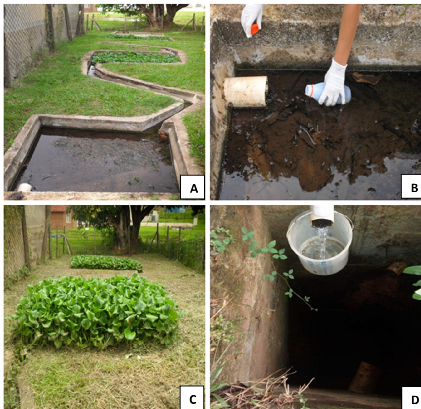
Figura 4. “Wetland” construído no setor de ranicultura do CAUNESP. A: Vista geral do “wetland” construído. B: Amostragem da entrada do efluente da ranicultura (IW). C: Compartimento com a macrófita E. crassipes . D: Amostragem da saída do efluente do “wetland” para os viveiros de piscicultura (WO).
