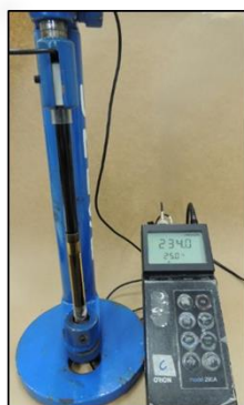
Fluoreto - Eletrodo específico (Orion 9409) - Eletrodo de referência (Orion 900200) - Analisador de ions (Orion 720A+).
