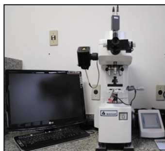
Microduromômetro Buehler Carga 5g; Tempo 10 segundos
