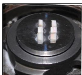
Embutimento dos blocos de esmalte com resina acrílica
