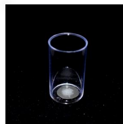
Desgaste ~50µm Lixa 400 (CARBIMET - BUEHLER)
