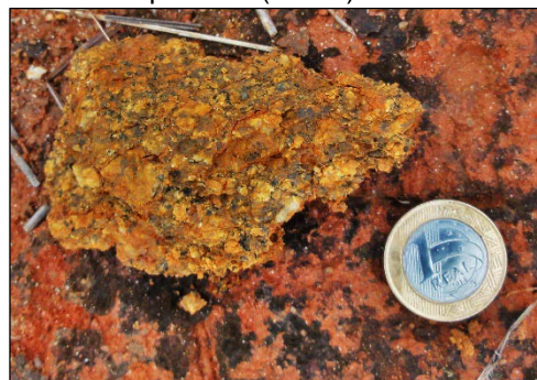
Figura 42 - Gnáisse muito alterado em material saprolítico (Pnt10).
