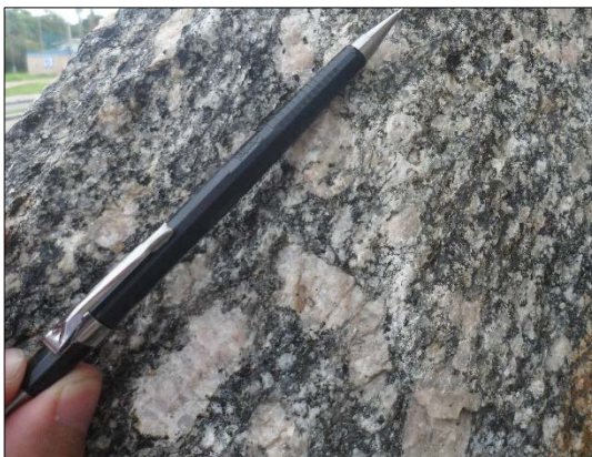
Figura 112 - Rocha de textura porfiroblástica, onde cristais grossos facoidais (1-4 cm) de feldspato potássico se encontram em matriz média (1-5 mm) subequigranular composta de plagioclásio, quartzo, feldspato potássico, biotita e hornblenda.
