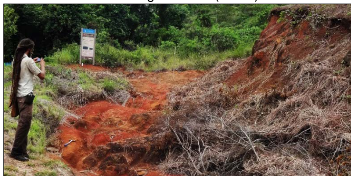
Figura 41 - Solo coluvionar muito argiloso vermelho amarelado sobre rochas gnáissicas (Pnt10).
