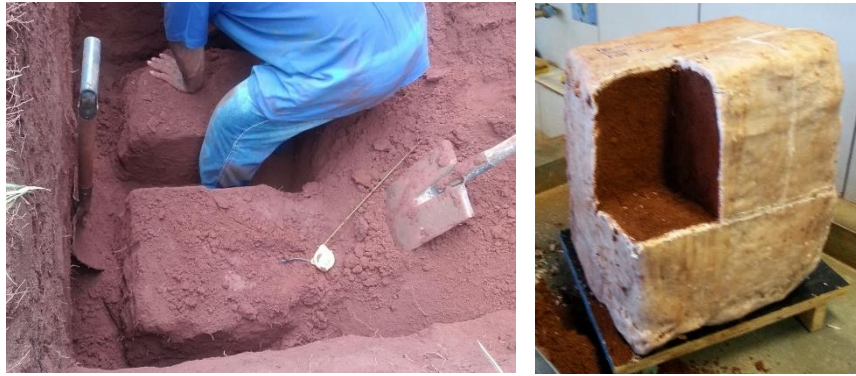
Figura 4.2 - Detalhe do momento de amostragem e, posteriormente, do bloco retirado em uso.
