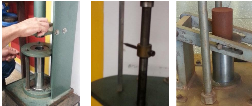
Figura 4.12 - Procedimento para moldagem dos corpos de prova, amostras indeformadas e compactadas.
