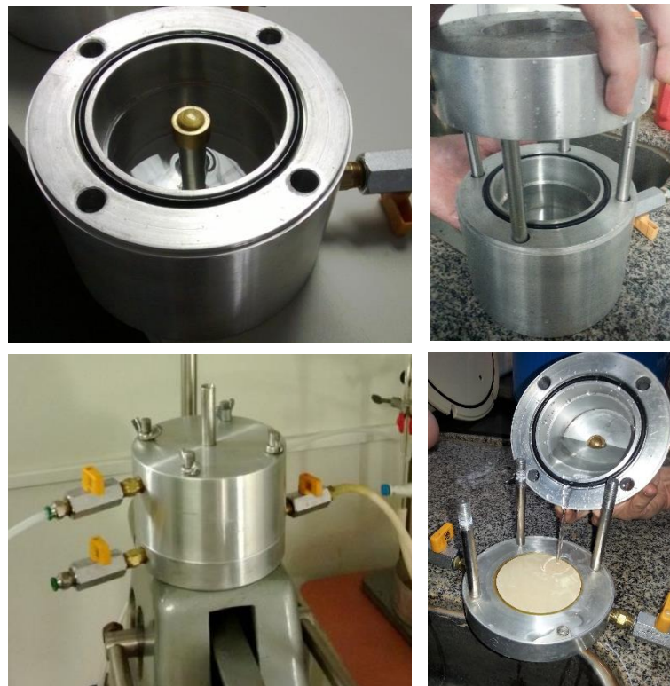
Figura 4.9 - Esquema de montagem da câmara edométrica para saturação da placa porosa HAEV.
