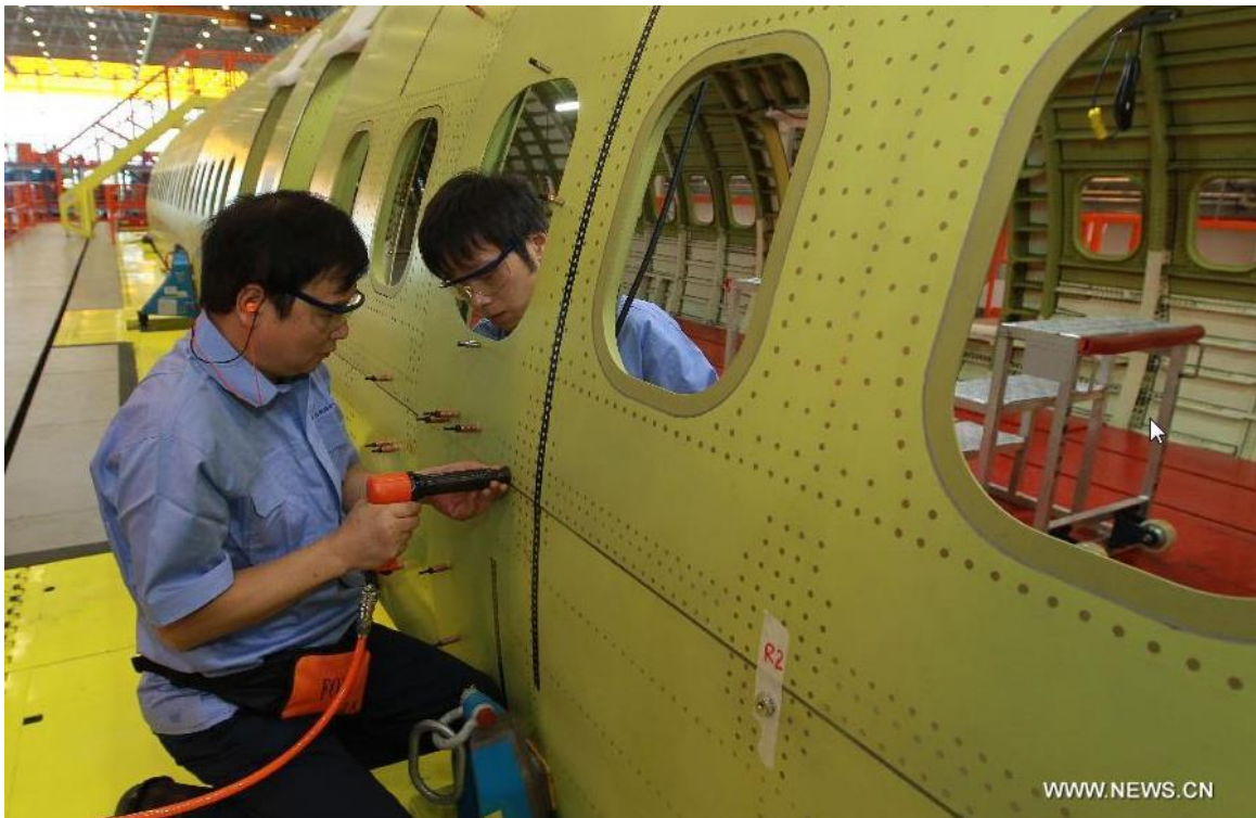
Figura 20 - Rebitagem Manual. Rebitagem convencional de rebite sólido
