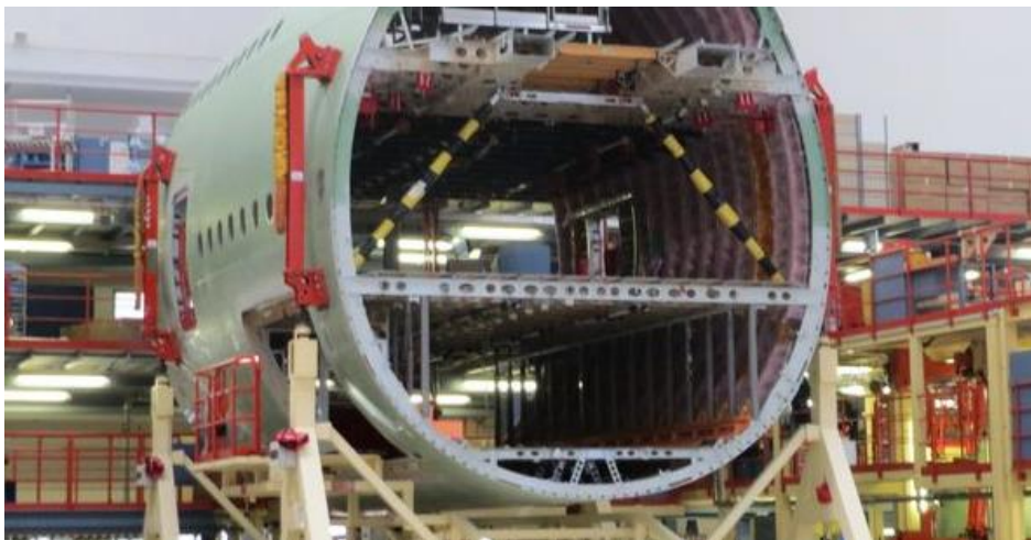
Figura 26 - Utilização de Tirantes na indústria Aeronáutica. Airbus A380-842
