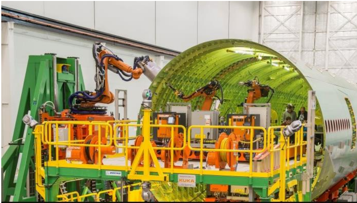
Figura 18 - Rebitagem Automática. Robôs de cravação da linha do Boing 777
