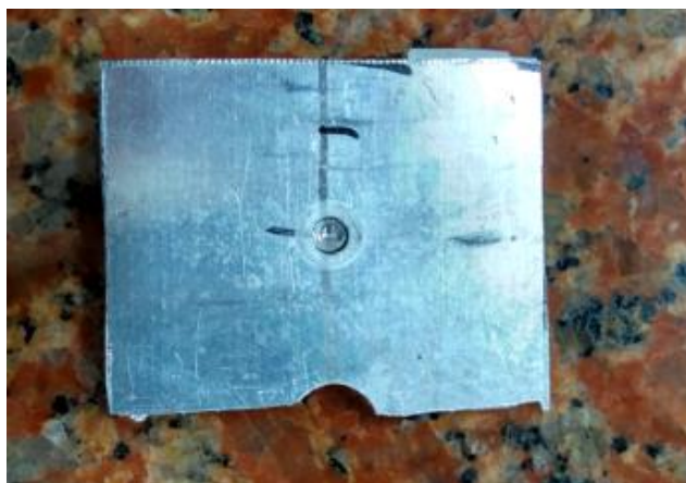
Figura 45 - Análise Metalográfica Efetuada na Região ao Redor do Rebite
