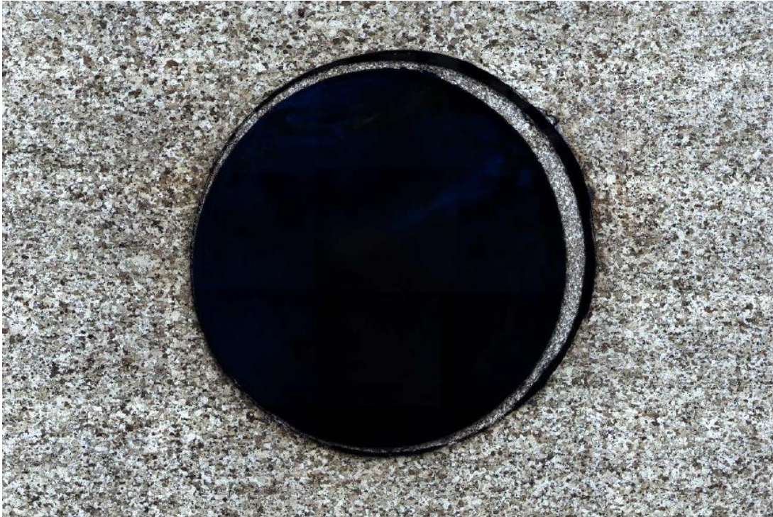
Figura 57 - Amostra peça 8 (2024 T3). Em destaque a microestrutura do material na região da cravação Ampliação 50X
