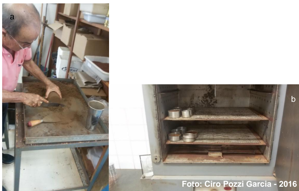
Figura 6 – Retirada o solo da parte superior e inferior da amostra cilíndrica (a). Amostras colocadas em estufas a 105°C por 48h (b)
