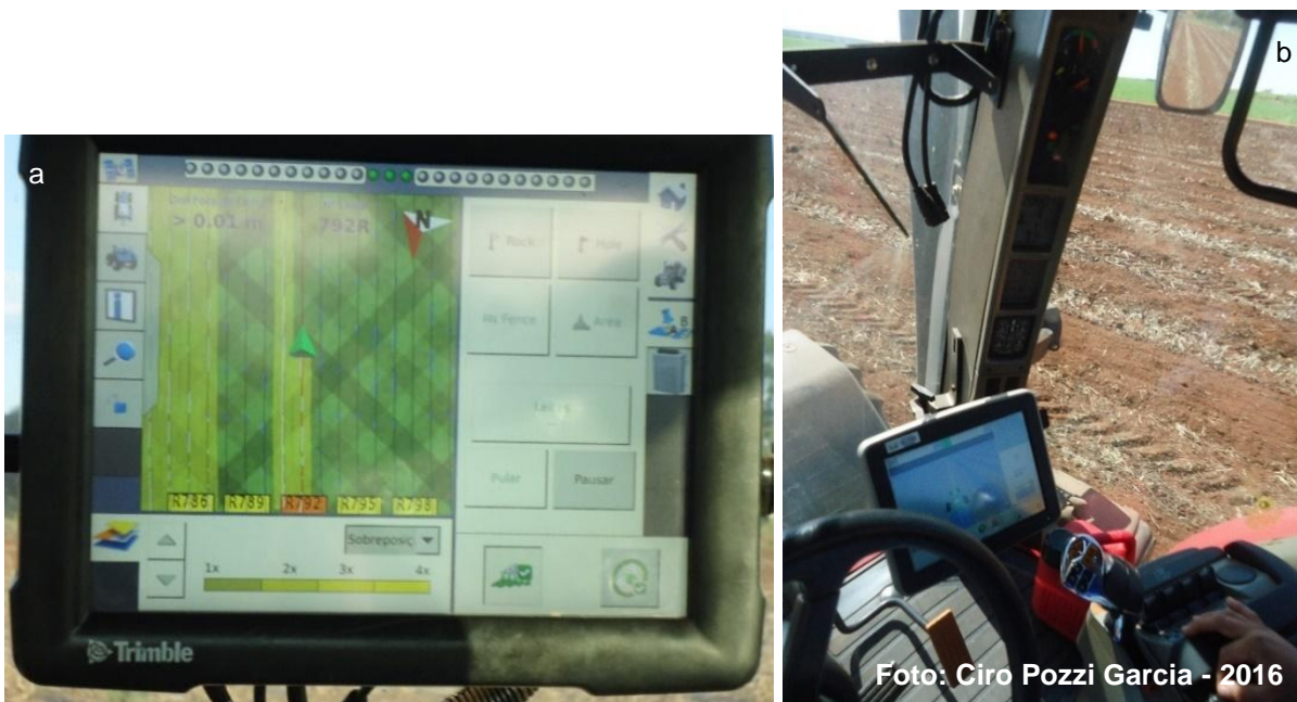
Figura 12 – GPS utilizado para controlar o tráfego na área (a). Tratos operando com piloto automático por meio de gps (b)
