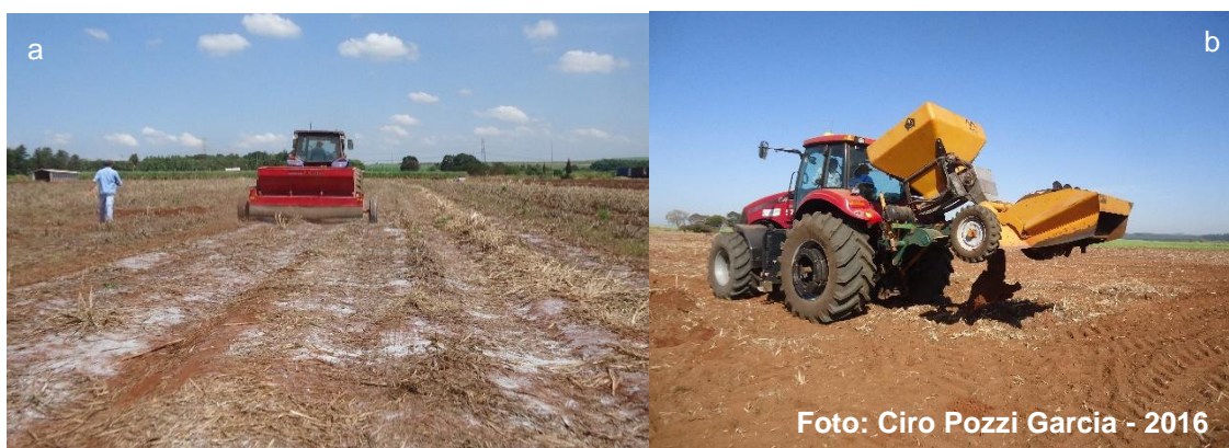
Figura 10 – Aplicação de calcário em área total (a); Implemento Penta acoplado no trator (b)
