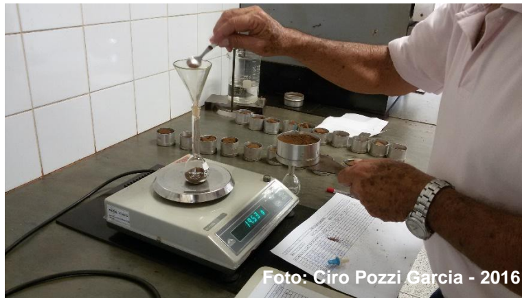
Figura 7 – Pesagem do solo dentro do Balão Volumétrico para posterior adição de álcool anidro
