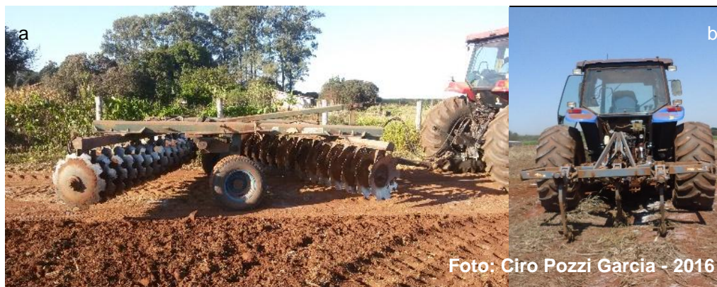
Figura 9 - Grade utilizada no preparo de solo da área com profundidade operacional de 35 cm (a). Subsolador de três hastes com profundidade operacional de 55 cm (b)
