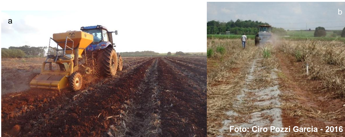
Figura 11 – Processo de canteirização formado pelo Penta (a). Aplicação de calcário em faixa (canteiro) (b)
