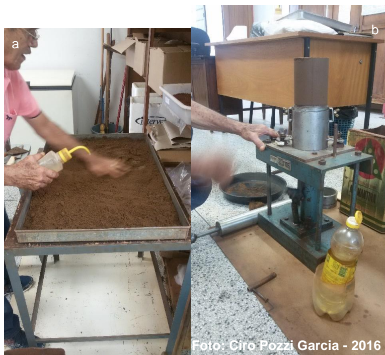
Figura 5 – Umedecimento das amostras de solo em bandeja (a). Amostra de solo compactada é retirada do extrator(b)
