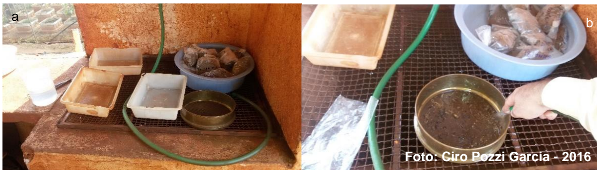
Figura 17 - Sacos de amostras congelados foram colocados em bacia com água afim de acelerar o derretimento (a). Lavagem das raízes em peneira 1mm com jato dirigido (b)
