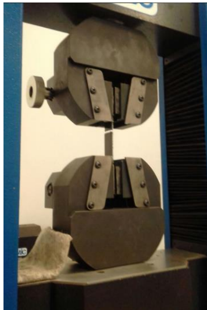
Figura 5. 2 Ensaio de tração do compósito.
