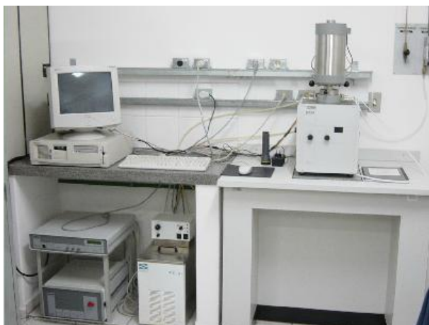
Figura 4. 1 Equipamento de análises térmica modelo STA 409 marca NETZSCH.
