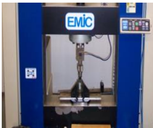
Figura 5. 5 Ensaio de flexão do compósito.
