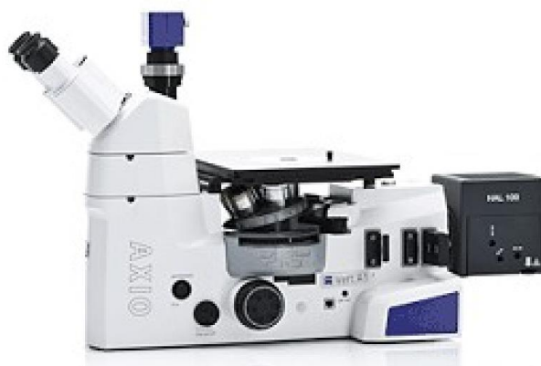
Figura 4. 7 Microscópio óptico de platina invertida Carl Zeiss.
